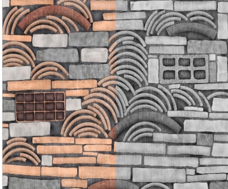
FOTO 3 L'Esterno utilizzando le proprie macerie
